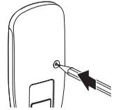
Pour activer une télécommande qui est verrouillée, appuyez sur le bouton à l'arrière de la télécommande pendant plus de 5 secondes jusqu'à ce que la led à l'avant de la télécommande clignote 2 fois.
