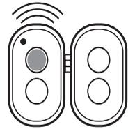
Tout en laissant le bouton de la première télécommande enfoncée, appuyez sur le bouton de la seconde télécommande que vous souhaitez programmer. La led de la deuxième télécommande va clignoter pendant 2 secondes, puis rester fixe.
