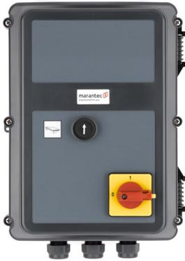
El cuadro de control básico para rampas de carga RS 200 se utiliza exclusivamente para controlar rampas de carga con una cuña abatible y una válvula. Aunque su gama de funciones es limitada, el RS 200 dispone de serie de un bloqueo de arranque, detección de fallo de fase, protección contra sobrecarga integrada y la posibilidad de enclavamiento mediante un cuadro de control de puerta externo.
